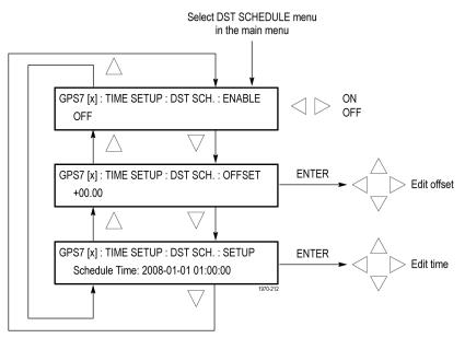
Figure 3-64: GPS7 module DST SCHEDULE submenu
