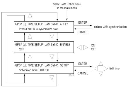
Figure 3-66: GPS7 module JAM SYNC submenu
