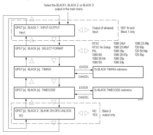
Figure 3-57: GPS7 module BLACK submenu
