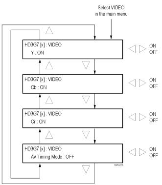
Figure 3-90: HD3G7 module VIDEO submenu
