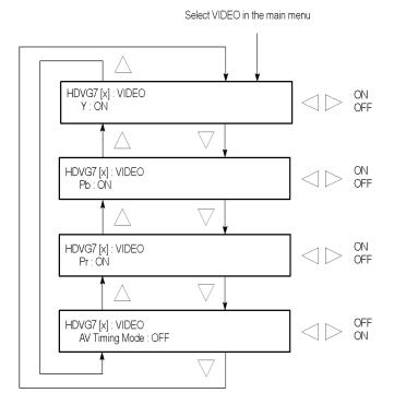
Figure 3-111: HDVG7 module VIDEO submenu
