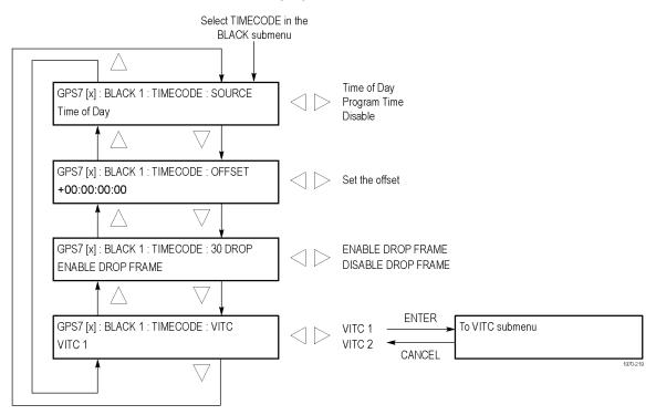
Figure 3-59: GPS7 module TIMECODE submenu
